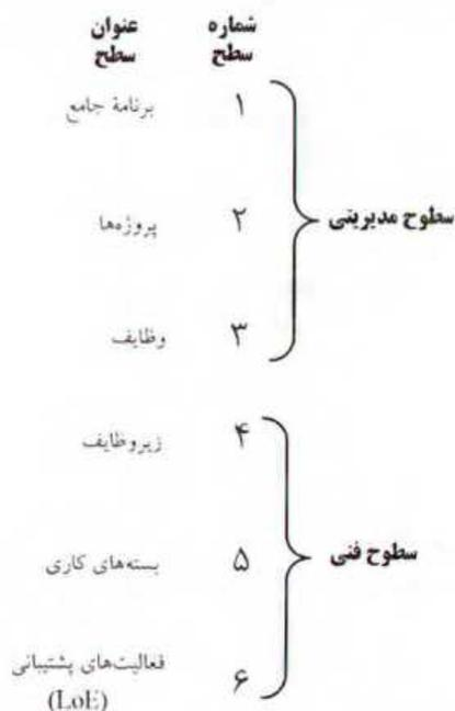
در تهیه ساختار شکست کار ابتدا باید عناصر سطح یک، سپس سطح دو و پس از آن سایر سطوح، مشخص شوند تا ساختار شکست کار تکمیل شود. در شکل ۲.۳ بخشی از یک ساختار شکست کار مربوط به برنامه ساخت محصولی فرضی، نشان داده شده است.
