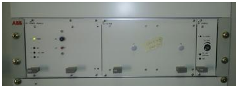
از راست به چپ: کارت هایبرید، کارت Tx، کارت تغذیه
